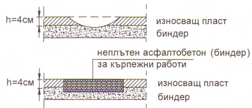
ДЕТАЙЛ No4 -Изкърпване на дупки
