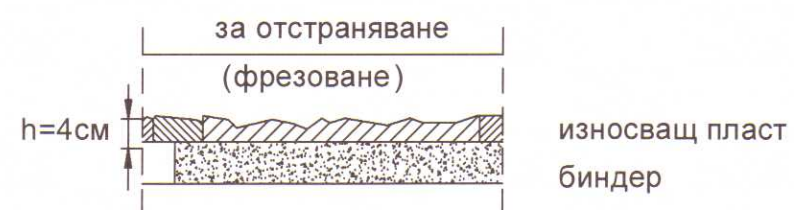
ДЕТАЙЛ No1 - Фрезование на повредени площи
